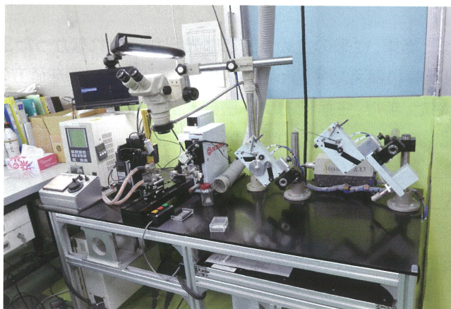
▲ものづくり補助金により導入した機器で作成した白金線巻き装置
