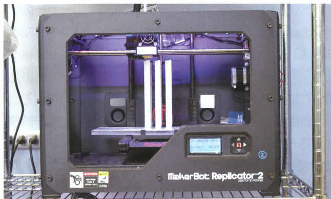
▲3Dプリンターで部品の約9割を製造
