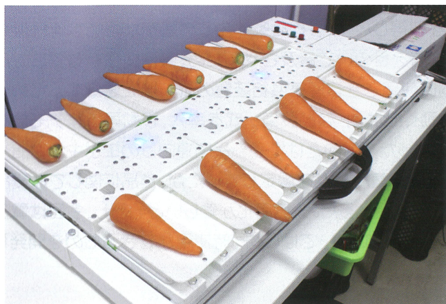
▲低価格化・軽量化・多様性化を実現した組合せ計量機「テーブルコンビ」
