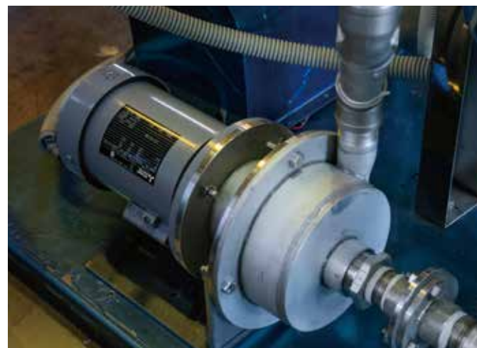
レーザー切断加工機にて製作した循環ポンプ
