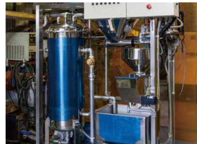
レーザー切断加工機にて試作した豆乳煮沸釜
