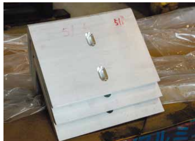
導入したマシンで制作した使用済み核燃料用輸送容器のアルミ部品
