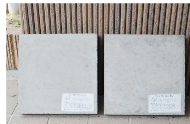
▲フライアッシュを配合したもの(左)と配合していないもの(右)。配合した方の表面が比較的なめらかになっている
