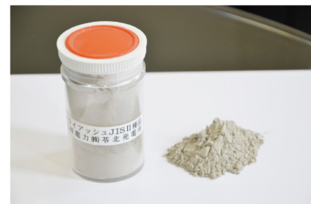
▲石炭を燃焼することで生じる粉状の炭「フライアッシュ」
