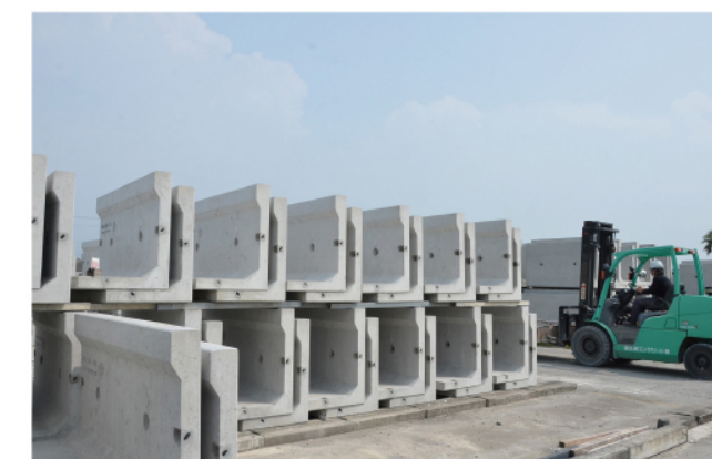
▲L字型擁壁。同社の製品は全てフライアッシュを配合している
