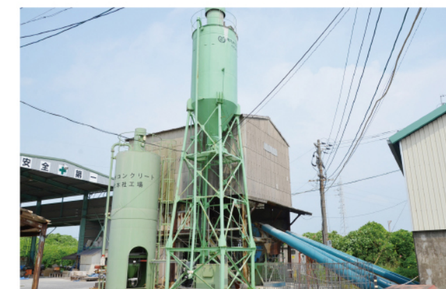
▲既存の製造プラントを改造して試験を行った結果、フライアッシュ配合の技術ノウハウを確立
