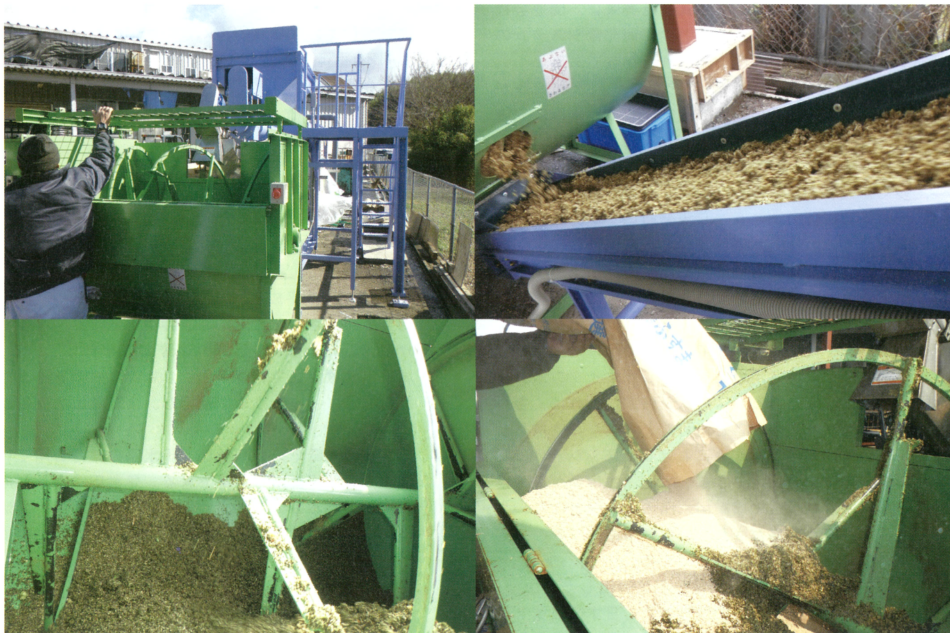
大分もやし協業組合が導入した飼料化工程システム。生成された飼料は大分県産業科学技術センターのサイレージ化試験にも合格した。
