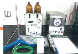
分析カラムの作成(中圧 高流式スラリー充填機)
