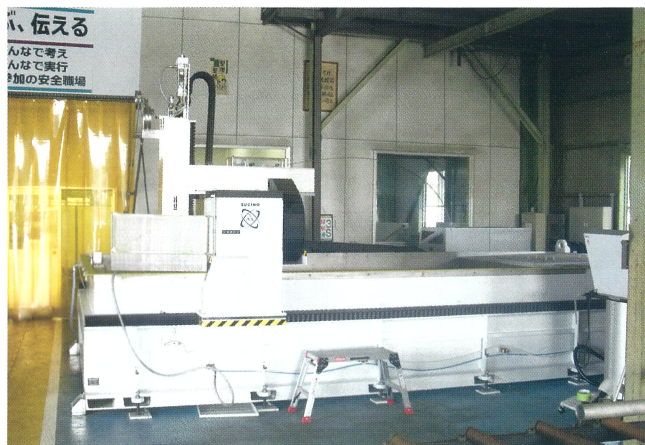
設置したアブレシブジェットカッター
