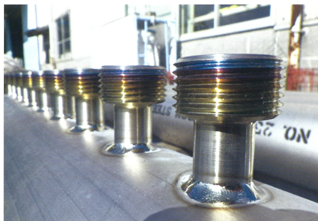
開孔部に溶接加工されたチタン製ノズル
