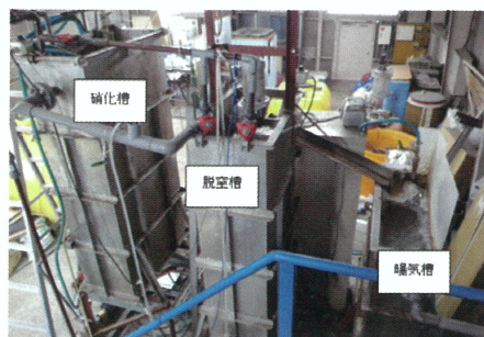
パイロットプラント試験機《硝化/脱窒連続処理》
