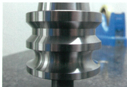
R部分の仕上げ・Rの成形
