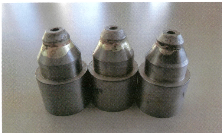
超硬をロー付け後の製品
