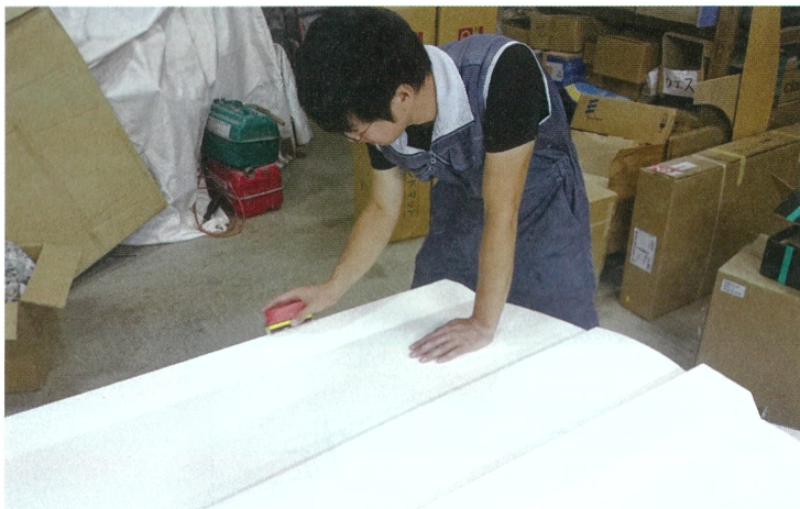
マスター型の手作業成型（サンドペーパー掛け）
