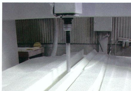
ボート（ウレタンのマスター型）の機械成型
