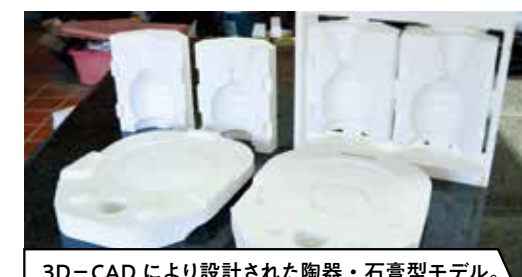
3D-CADにより設計された陶器・石膏型モデル。 写真手前は排泥鑄込成型では製造できなかった 圧力鑄込用丸皿石膏型
