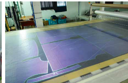
プロジェクターで生地に投影されたCADのマーキングデータを目視で確認する
