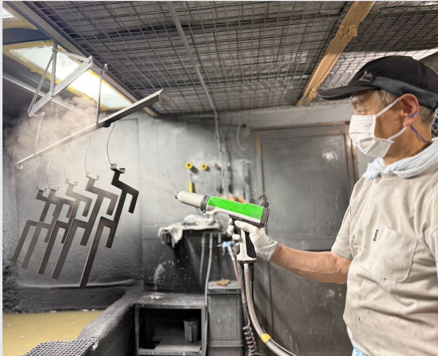
導入した粉体塗装用のガンによる作業の様子 作業効率が大幅に向上
