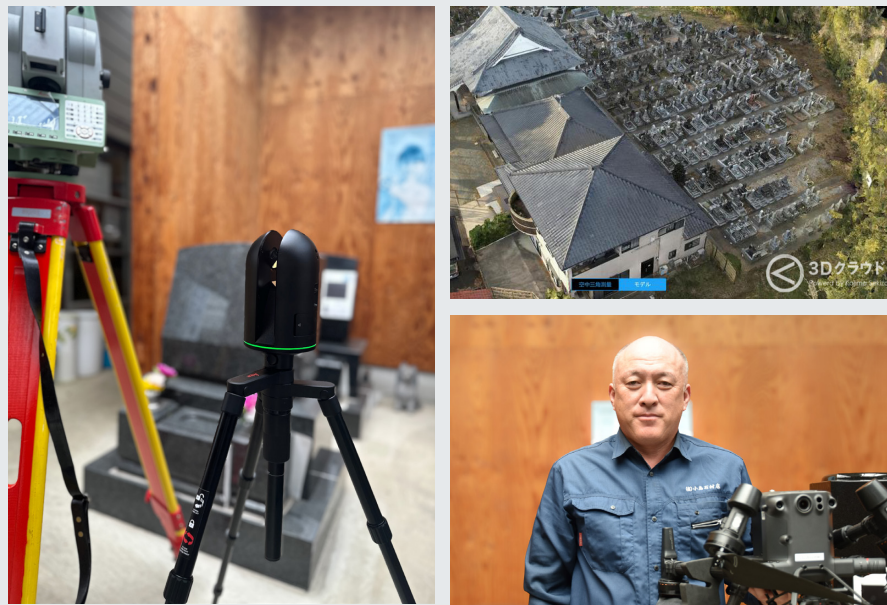
左/左側が従来のTS機器、右側が地上型レーザースキャナー 右上/写真と見間違ふほどの3Dモデル 右下/新たに導入した測量用のドローンを持つ代表取締役の小嶋 博文社長
