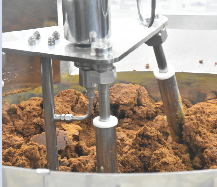
カレールーを仕込む様子 各種センサーとコンピューターが連動し、一定の品質を管理している
