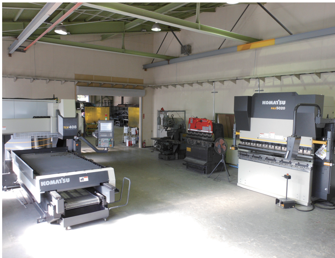
補助金を活用して導入した2次元CO2レーザー加工機と長尺折曲機
