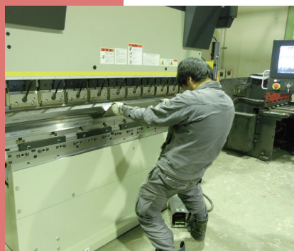
長尺折曲機での作業の様子
