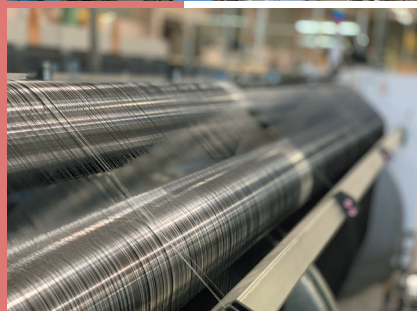
原料糸を整経、製織する装置
