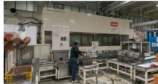
炭化水素系真空4槽式全自動洗浄機
