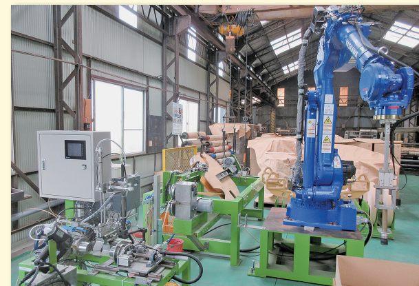
導入した産業用ロボットと紙ひも加工機一式
