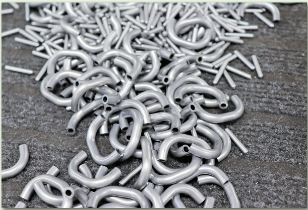
完成したリターンパイプ
