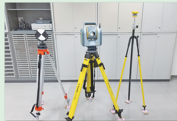
導入されたTLS（地上型レーザースキャナ）
