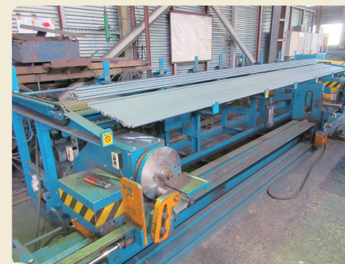
導入した鉄筋自動曲げ加工機
