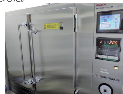
新設した無塵熱風強制循環式定温乾燥機
