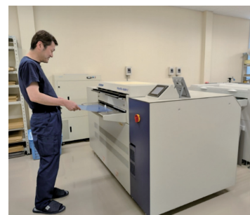
RIPシステムをインストールしたパソコンと サーマルプレートレコーダー刷版出力機
