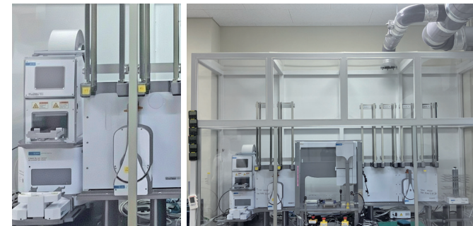
導入した機器の遠心機（左） 導入した機器と既存システムを統合し、多検体自動処理を実現（右）
