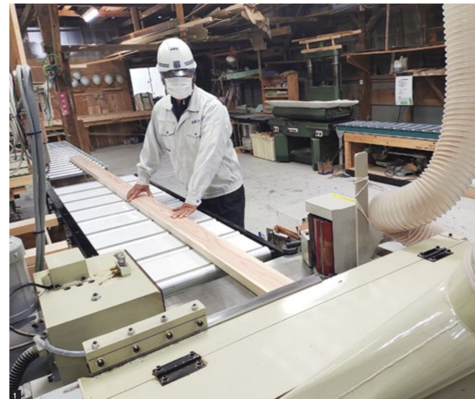
1 縦軸付自動かな盤の導入で大型建築部材の加工も可能に 2 神社仏閣工事には定評がある 3 受け継がれている宮大工の高い技術
