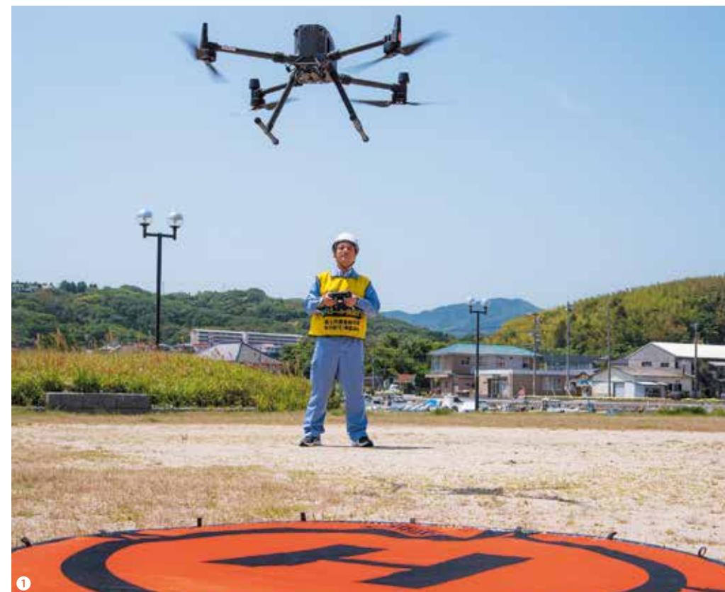
①導入した大型ドローンとレーザースキャナーで3次元レーザー測量が可能になった ②データ解析中の画面 ③3Dモデルで分かりやすく ④チームワークで顧客の要望に応える
