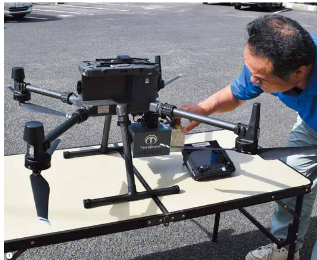
①導入したレーザー scanner 搭載のドローン ②現場でレーザー scanner 搭載ドローンを飛ばし測定する作業員 ③現場の正確な位置を測定するGNSS固定局 ④くさび型アンカーの設置作業
