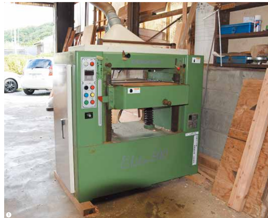
①重厚な製材を可能にした自動一面鉋盤 ②製材された幅広い天井板 ③製作された長椅子 ④製作された下駄箱
