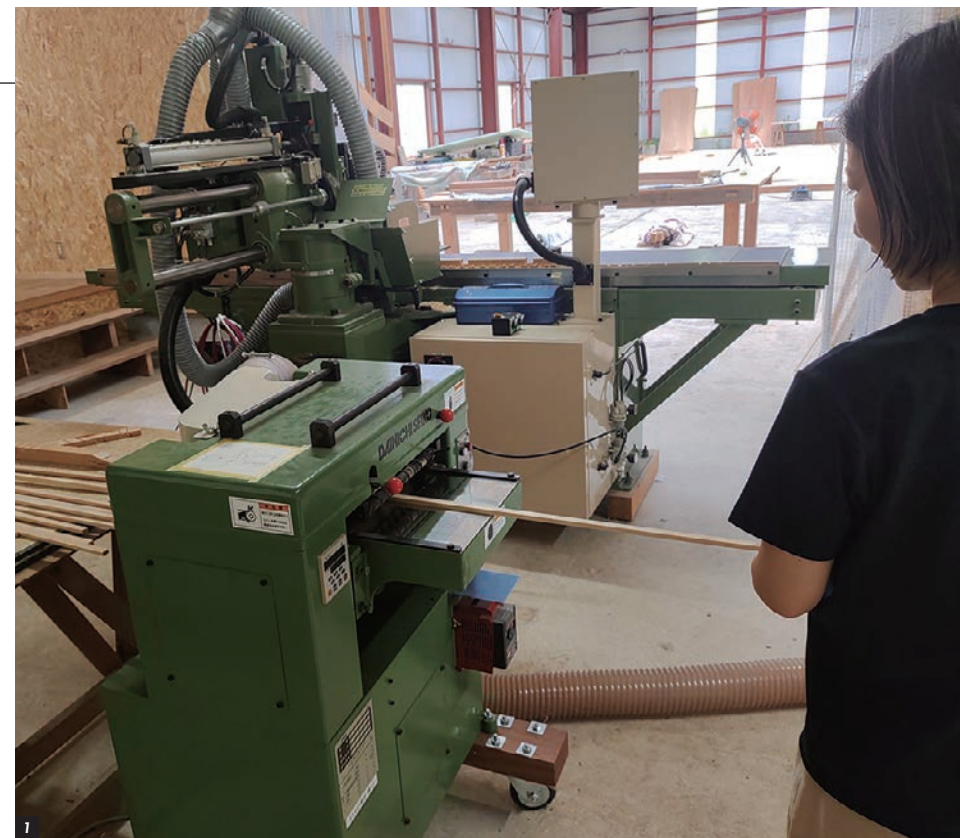
1.1ミリ以下に削れる組子用自動一面かんな盤 2.新たに導入した組子細工機「全自動NCラジアルソー」 3.機械を活用することで、経験の浅い社員でも繊細な組子加工が可能に(試作品)
