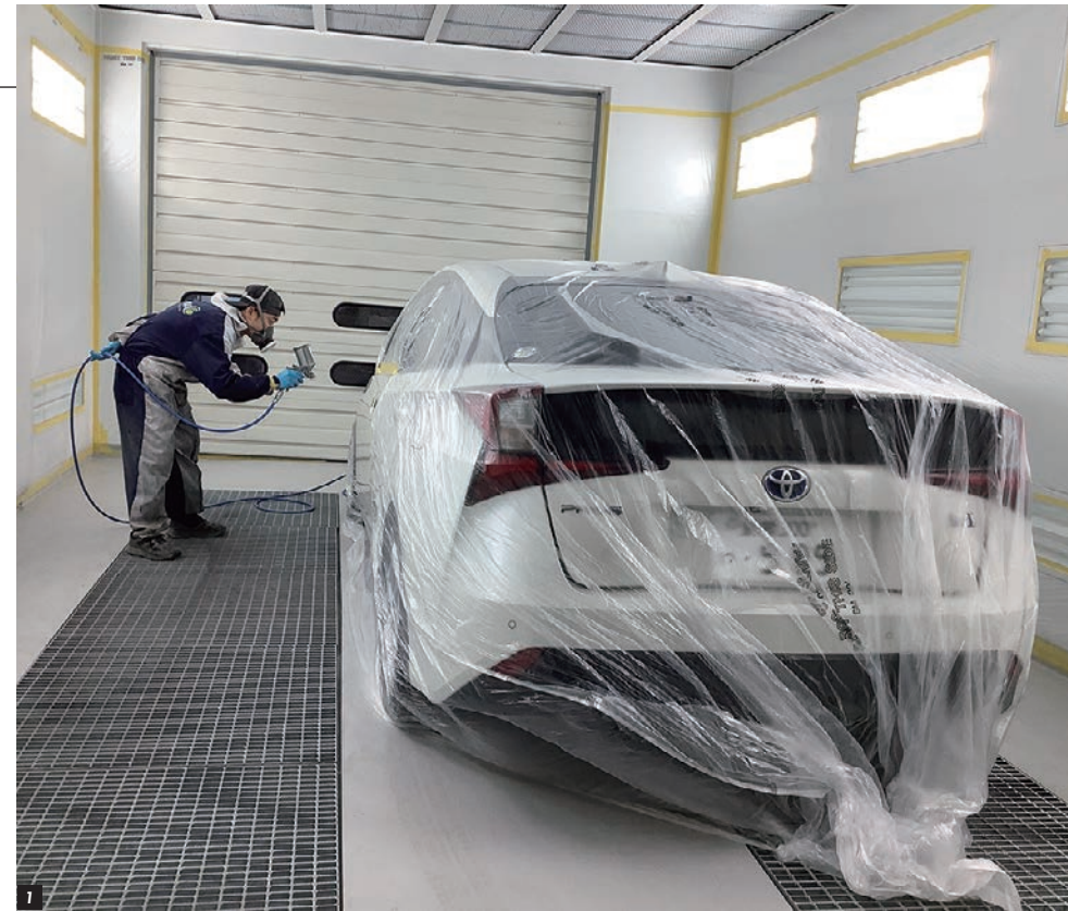
1.2.3.乾燥ブースの導入で、水性塗料での塗装が能率的になった 4.塗料が並ぶ調色室。ぴったりの色に仕上げる
