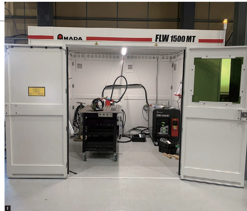
1.遮光用の部屋に設置されたレーザー溶接機 2.ハンディファイバーレーザー溶接機の本体 3.スリットセーバー 4.前処理に用いる凝集剤溶解装置
