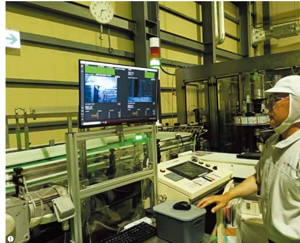
①AIカメラが撮影した画像をモニターで確認する工場スタッフ ②AIカメラは、ペットボトル内の異物混入も瞬時にチェックする ③工場内の様子 ④営業強化を進めるオリジナル商品の数々
