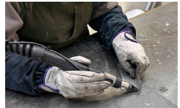
▲レーザービームで歪みや焼けのない溶接を実現
