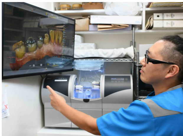
削りだし加工を行うミリングマシン。歯科技工を行ってきた経験から精度を高めるための独自のノウハウも確立できた
