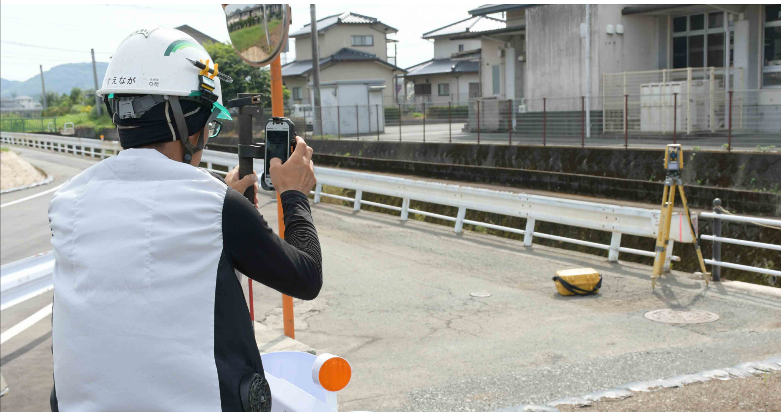
自動追尾機能のある測定器(写真右)を導入したことで、従来2人で行う必要があった測量業務が一人に対応可能に
