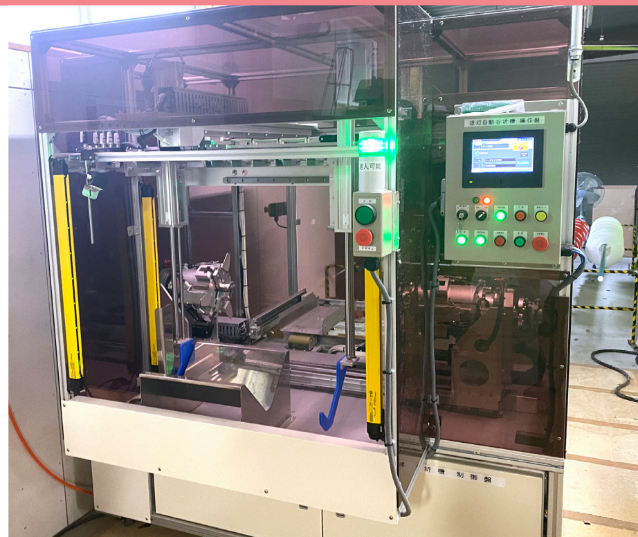
本事業で導入した自動折機。自動的にセットされた提灯はジャバラ状に折りたたまれていく
