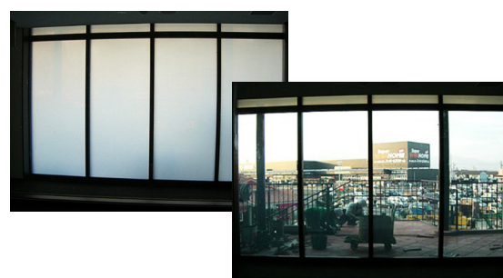
「機能性液晶フィルム」を採用した商業施設の通電時(写真左)と非通電時
