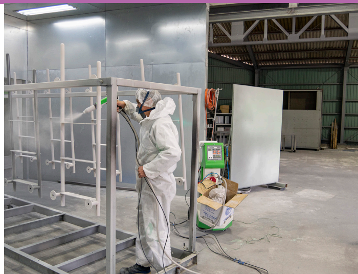
製品にパウダー状の粉体塗料を噴射し、電気的に付着させる
