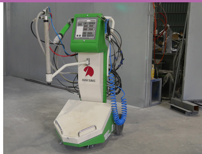
静電粉体塗装機「デュアル電界方式粉体ハンドガンユニット」
