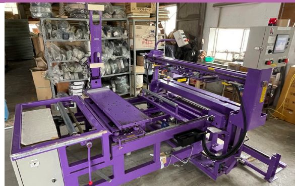
畳床切断・畳表張付を行う「表張・框縫付自動片框裁断機」
