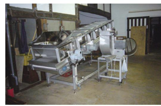
釜場に設置した冷却機
