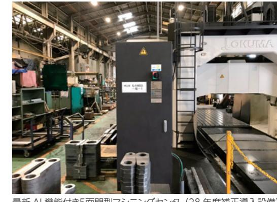
最新AI機能付き5面門型マシニングセンタ（28年度補正導入設備）
