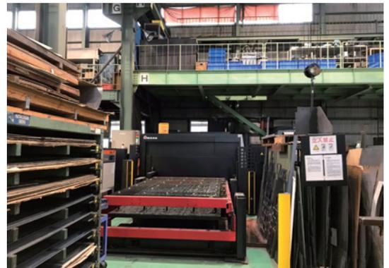
ファイバーレーザー切断加工機（27年度補正導入設備）
