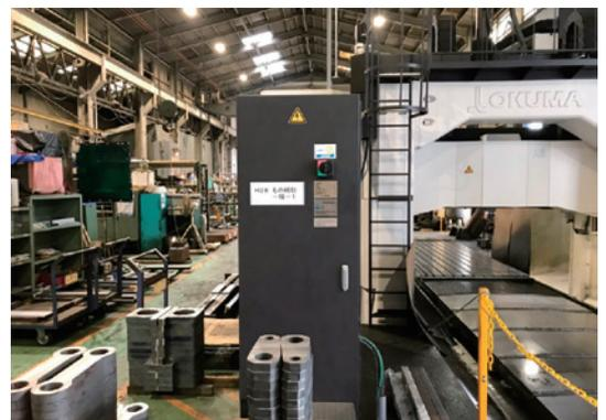
最新AI機能付き5面門型マシニングセンタ（28年度補正導入設備）
