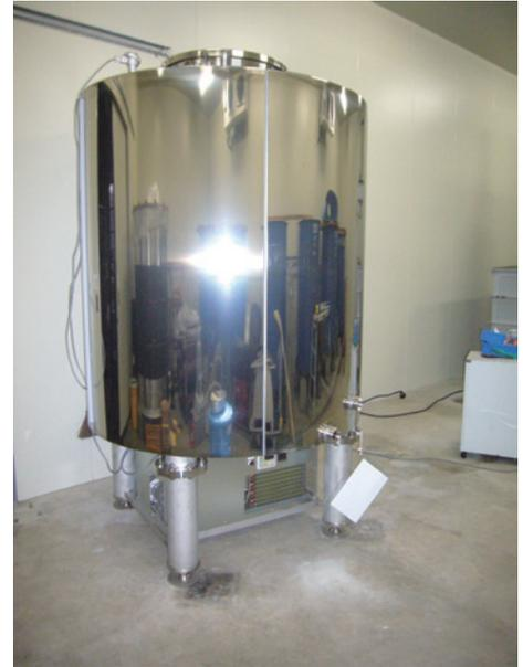
土蔵に設置した温度調整タンク
