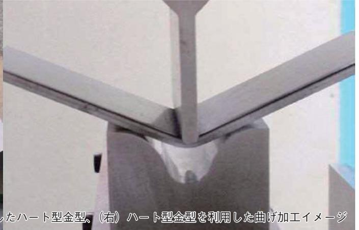
(左) 開発したハート型金型、(右) ハート型金型を利用した曲げ加工イメージ
