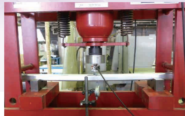
「JIS T 9201（手動車椅子規格）」に基づく強度試験
