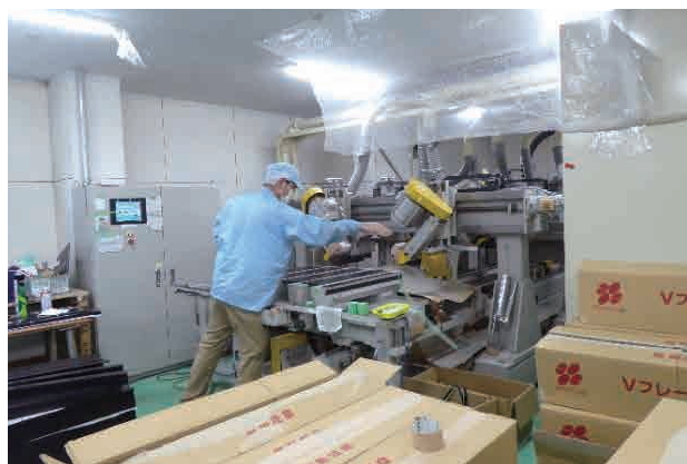
H 27 年補助金で導入「マイコン制御 2 軸全自動 V 角カットソーマシン」
