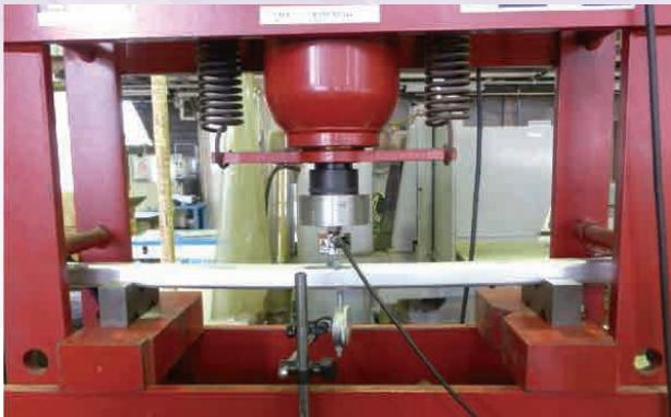
「JIS T 9201（手動車椅子規格）」に基づく強度試験
