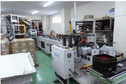
H 29 年補助金で導入 「枠材自動クルミ機」
