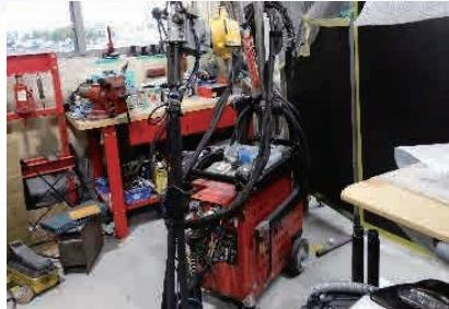
導入した高度スポット溶接機と溶接面
