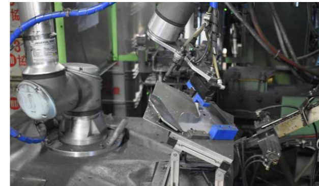
協働ロボットの導入では専用治具も開発
