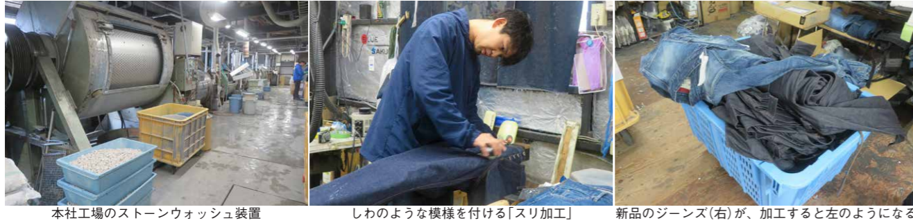
本社工場のストーンウォッシュ装置 しわのような模様を付ける「スリ加工」 新品のジーンズ(右)が、加工すると左のようになる
