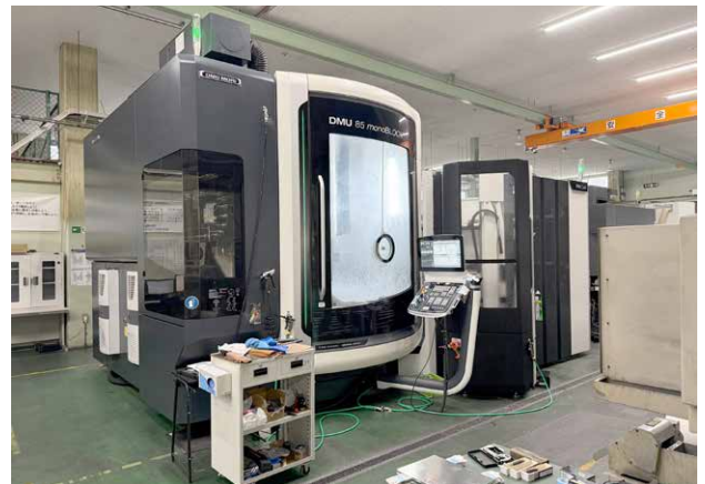
小型部品の加工を自動化するため導入した5軸複合加工機
