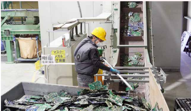
廃基板を破砕機に投入
