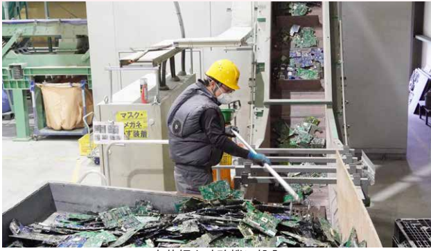
廃基板を破砕機に投入
