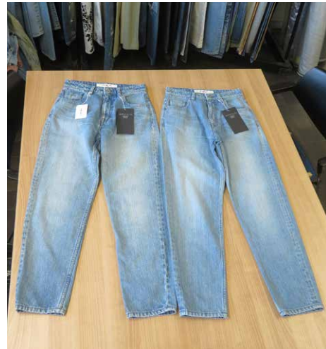
ナノミスト加工したジーンズ(左)と従来加工のジーンズ(右)
