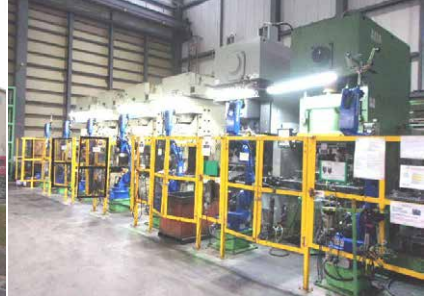
プレス機とロボットを組み合わせた自動化システム
