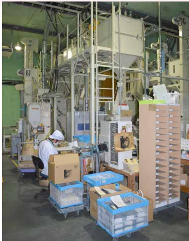
割れ米の混入を減らした新精米ライン
