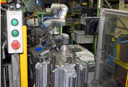
フェンダーエプロン生産に導入した協働ロボット
