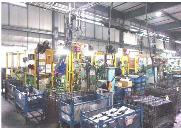
新たに導入したスポット溶接ライン
