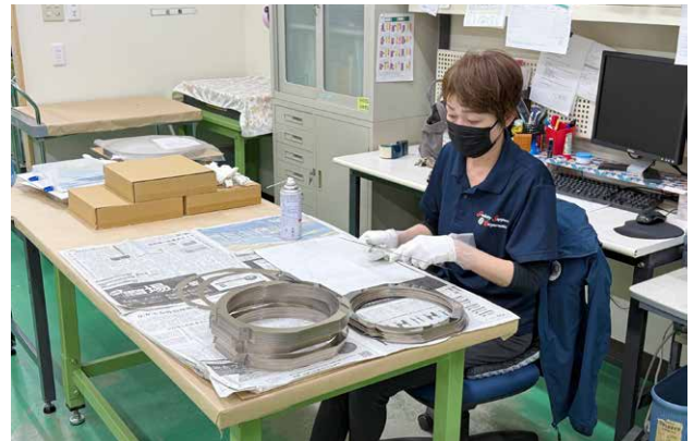
再研磨後のテーブルフレームを目視で検査
